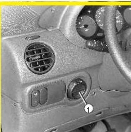
Bouton 1 permet à la hauteur de l' faisceaux à être modifié par rapport à la charge.
