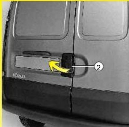
Ouverture des portes à commande manuelle à partir de l'extérieur
