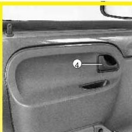
Ouvrir les portes manuellement à partir à l'intérieur du véhicule
