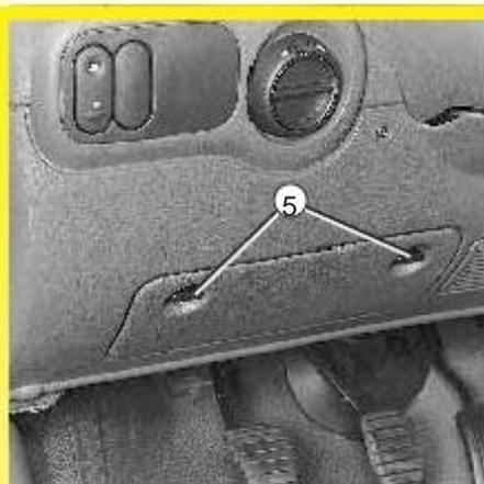
Ouvrir le couvercle 3(Sous la direction ) en soulevant la roue ergots 5.
