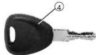
4 Clé de contact, des portes et bouchon de remplissage de carburant.
