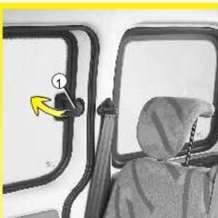
L'ouverture de la fenêtre sur le côté
