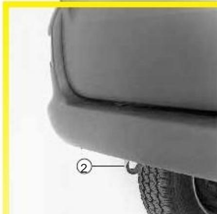
Utilisez uniquement l'avant 1 et à l'arrière 2 points de remorquage (Ne jamais utiliser le lecteur arbres). Ces points de remorquage peut être utilisée pour la traction: ne jamais utiliser les pour soulever le véhicule directement ou indirectement.
